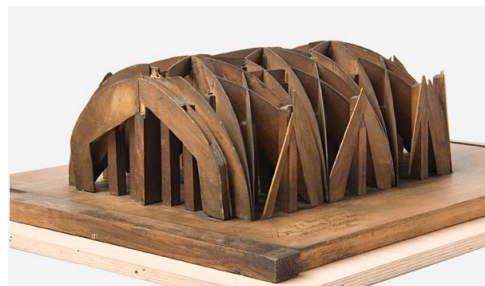
Abb. 20 ■ Lehrbogenmodell eines spätgotischen Sterngewölbes, 1659 (TUM, Architekturmuseum, heiss-1-1)
